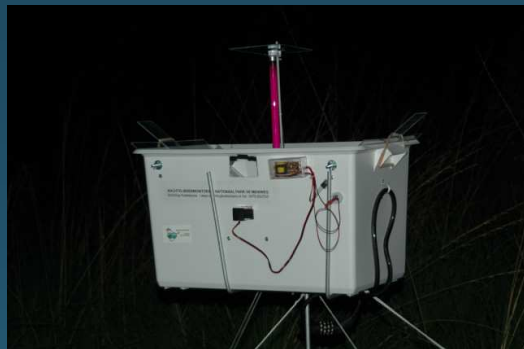
Nachtvlinderval blacklight 8 Watt / 12 V.
